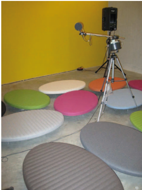
Figuur 9: meetopstelling meting 2 –eilanden op 13cm van vloeropp.
