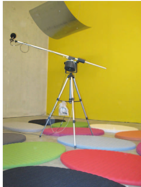
Figuur 5: meetopstelling meting 1-eilanden op vloeroppervlak
