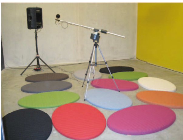
Figuur 4: meetopstelling meting 1- eilanden op vloeroppervlak
