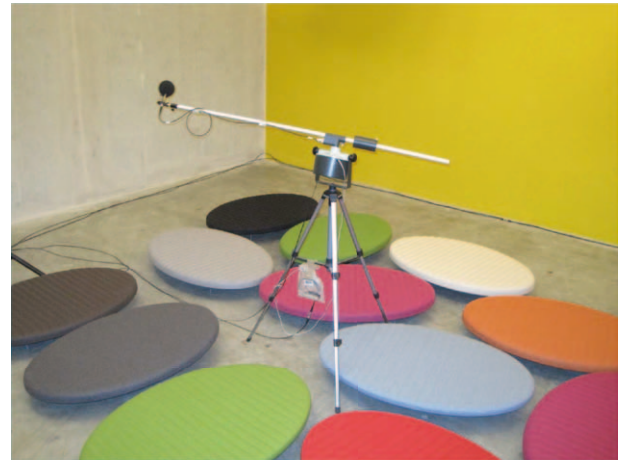
Figuur 10: meetopstelling meting 2 –eilanden op 13cm van vloeropp.
